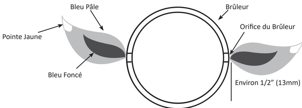
**Brûleur tubulaire** : Le brûleur est fait d'acier inoxydable 304, mais en raison de la chaleur extrême et d'un environnement corrosif, il se produira une corrosion de surface. Enlevez cette corrosion à l'aide d'une brosse en laiton. Nettoyez les orifices bouchés à l'aide d'un trombone déplié. N'agrandissez surtout pas les orifices du brûleur.
