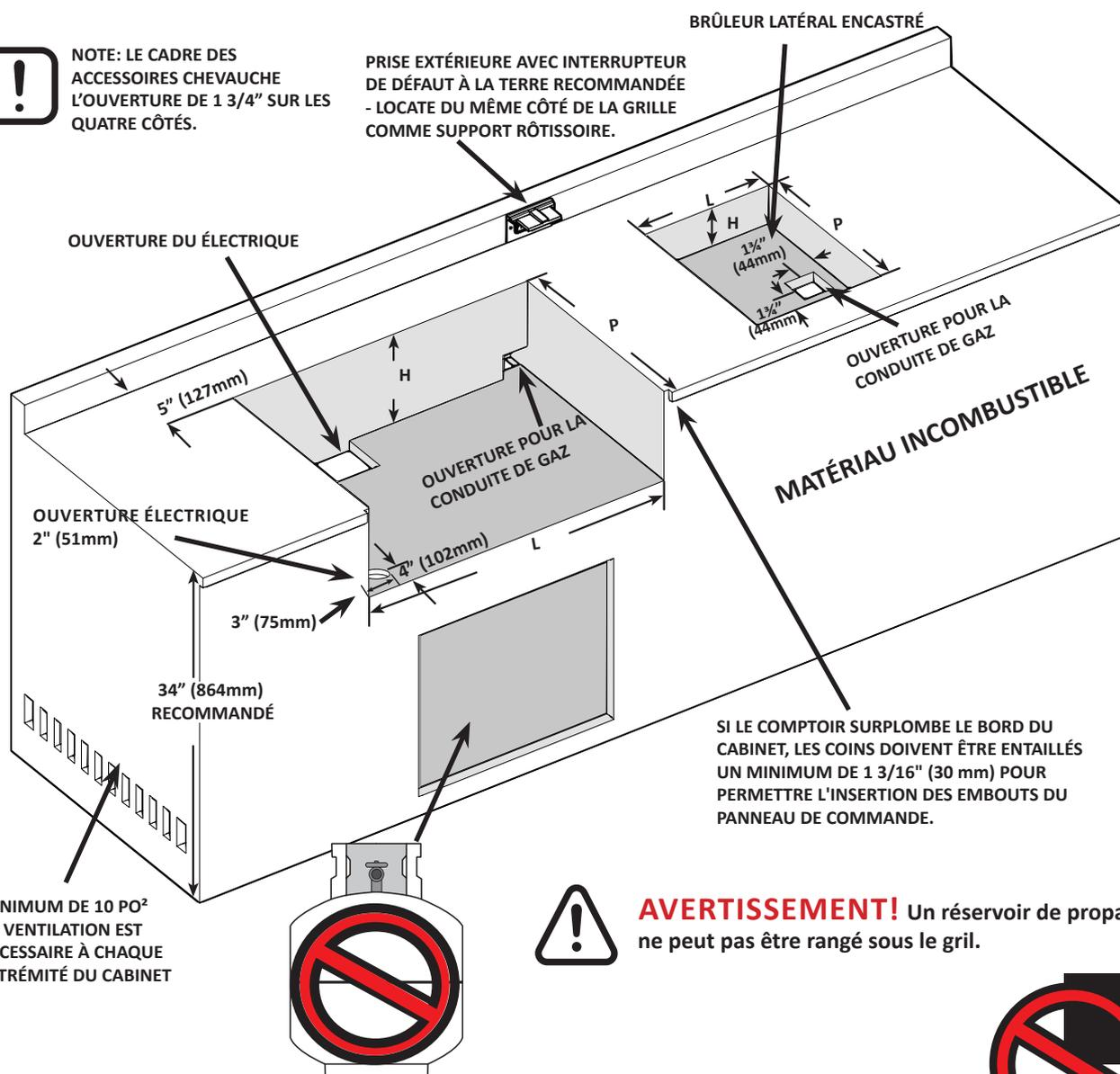
MINIMUM DE 10 PO<sup>2</sup> DE VENTILATION EST NÉCESSAIRE À CHAQUE EXTRÉMITÉ DU CABINET
