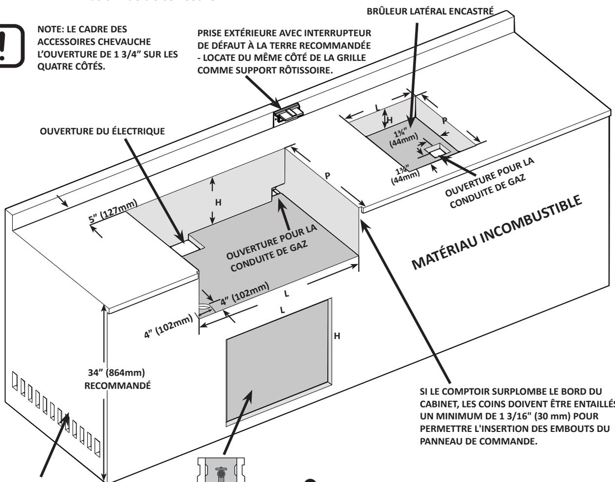
MINIMUM DE 10 PO<sup>2</sup> DE VENTILATION EST NÉCESSAIRE À CHAQUE EXTRÉMITÉ DU CABINET
