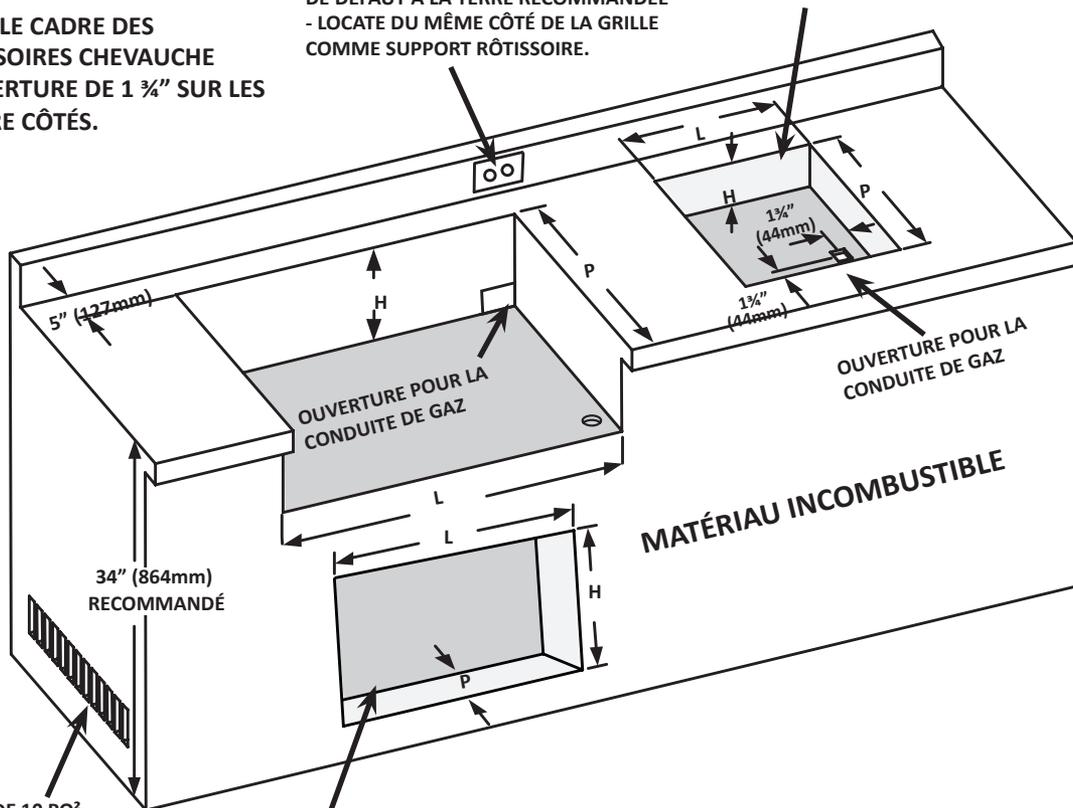
MINIMUM DE 10 PO<sup>2</sup> DE VENTILATION EST NÉCESSAIRE À CHAQUE EXTRÉMITÉ DU CABINET
