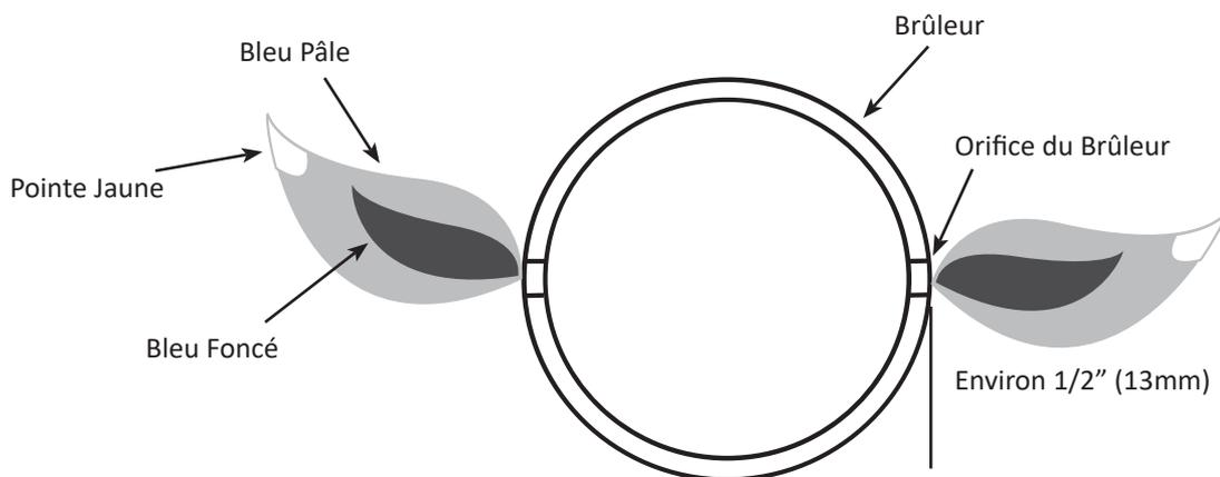
**Brûleur tubulaire** : Le brûleur est fait d'acier inoxydable 304, mais en raison de la chaleur extrême et d'un environnement corrosif, il se produira une corrosion de surface. Enlevez cette corrosion à l'aide d'une brosse en laiton. Nettoyez les orifices bouchés à l'aide d'un trombone déplié. N'agrandissez surtout pas les orifices du brûleur.
